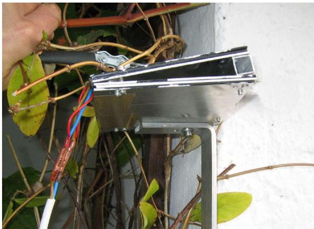
Die beiden Spalten sind aus Aluminiumblechen gefertigt, mit einem Abstand von 2 mm. Zur Vermeidung von Reflexion sind die Platten innen schwarz lackiert und der Lack-Glanz ist durch Anschleifen entfernt worden. Die beiden Fotowiderstände wurden parallel verbunden, damit sie mit einem Messkabel gemessen werden können.
