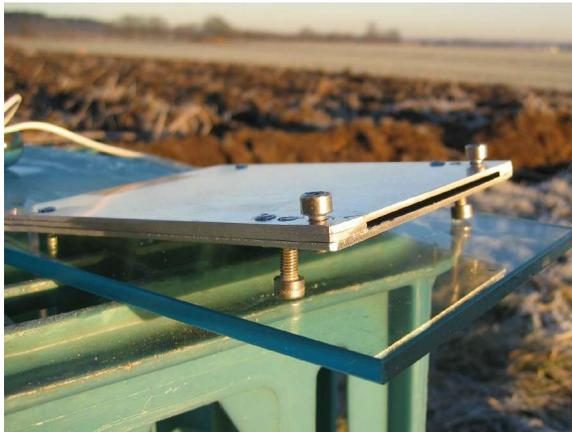
Bei der mobilen Messstation wird nur ein Spalt (2 mm) verwendet, dessen Winkel aber durch Umdrehen schnell verstellt werden kann. Die beiden Winkel sind mit den Schrauben oben und unten festgelegt. Als lotrechte Ebene dient eine Glasplatte.
