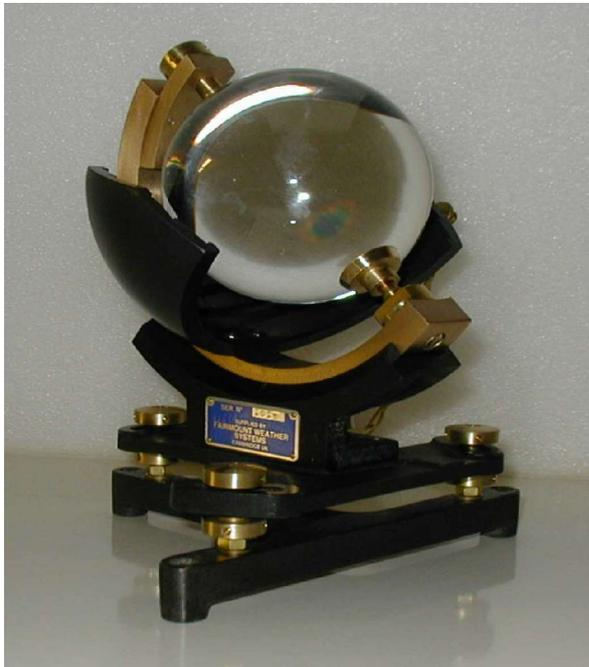
„Der sogenannte Campbell-Stokes-Schreiber brennt durch die Lupenwirkung einer Glaskugel die SSD als Spur auf einen Schreibstreifen.“<sup>1</sup> Aus der Länge der gebrannten Spur kann dann die Sonnenscheindauer (SSD) abgelesen werden. Die mit dieser bewährten Methode ermittelten Werte sind trotz neuerer elektronischer Messeinrichtungen am zuverlässigsten.
